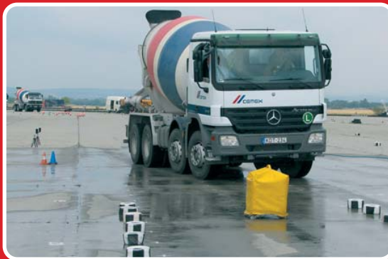
Fontos begyakorolni, hogy a blokkolásgátlóval szerelt járművek vészfékezés közben is irányíthatóak maradnak
