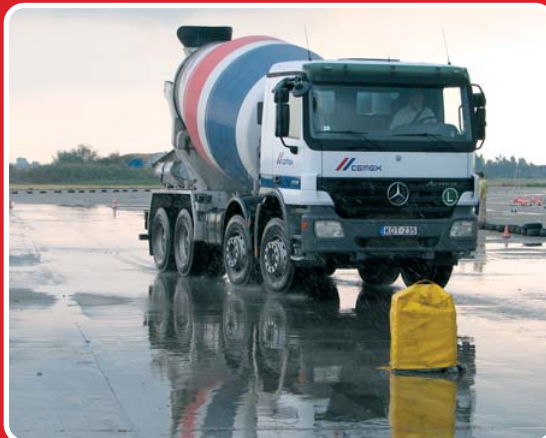
A fellocsolt műgyanta pályán a harmadára csökkent tapadási együtthatónak megfelelően a járművek fékútja is a háromszorosára nőtt, így eleinte még jobban „elszámolták” magukat a résztvevők. Nem véletlen, ilyen körülmények között ritkán vészfékeznek a mindennapokban
