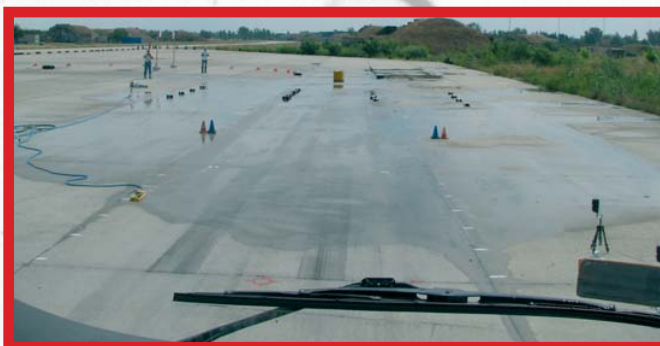
Így néz ki egy feladat a fülkéből. A fotocellás kapu méri a jármű belépősebességét, a kettős bójánál kezdődik a feladat végrehajtása, a sárga kocka pedig az akadály
